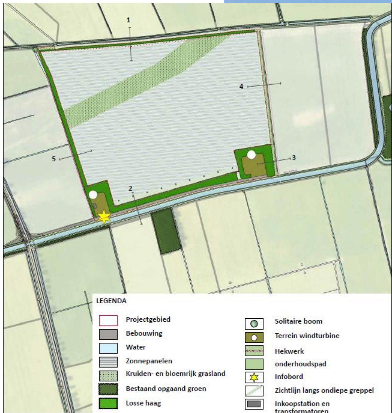
Afbeelding 30. Ontwerp zonnepark Bijvanck met aanduiding van de locatie van de dwarsprofielen
